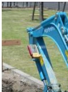
図10 レーザレベルとセンサ
