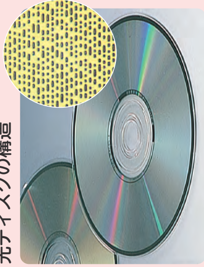
図 A CD と記録部分の拡大写真
