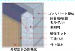
外壁部分の断熱化
