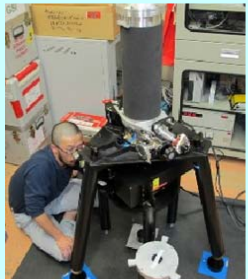
FG5絶対重力計による観測 (第51次隊)
