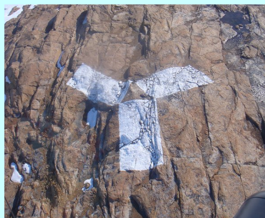
基準点に設置した対空標識
