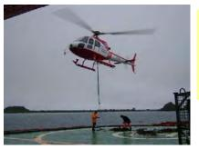
AS350B2 (1機使用) 胴体全幅 1.80m 胴体全長 10.93m 全 高 3.14m
