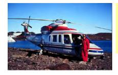
S76 (2機使用) 胴体全幅 2.13m 胴体全長 13.22m 全 高 4.41m
