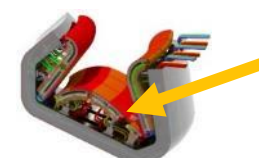
高熱負荷機器(ダイバータ)の設計
