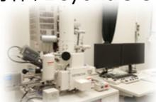
[装置の例] 高分解能走査電子顕微鏡
