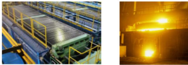
例：電気を大量消費する電解プロセス（左）および電炉（右）
