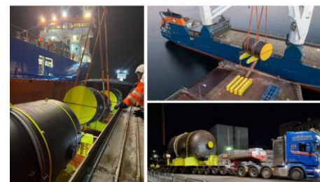
サイトに保管されている使用済蒸 気発生器の搬出 - サイクリフ スウェーデン施設での処理
