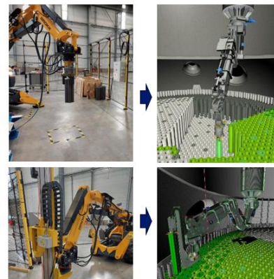
グローバルな解体シナリオを検証するため、デジタル／物理ツイン試験の採用決定(黒鉛除去の例)
