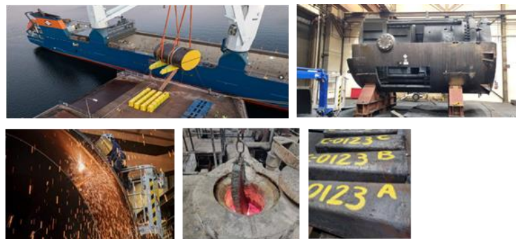
フェッセンハイム発電所で使用済み蒸気発生器 (SG) の上部構造の処理およびリサイクルに関する実現可能性の実証
