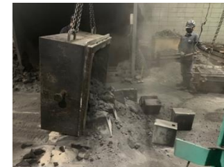
上左：熔融 上中：出湯 上右：注湯 中左：鑄込 中中：解砕 中右：ショットブラスト後 下左：保管
