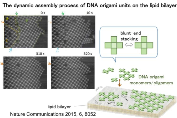
DNAオリガミ構造体が脂質二重膜-溶液境界で欠落/境界修復と再組織化を伴う成長など様々な現象によって再配置される。様々なボトムアップ型ナノテクノロジーの基盤技術となるもので、ナノデバイスの集積化・組織化や新規分子デバイス構築などへの展開が期待される。
