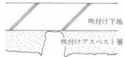
⑤ 層の局部的損傷・欠損
