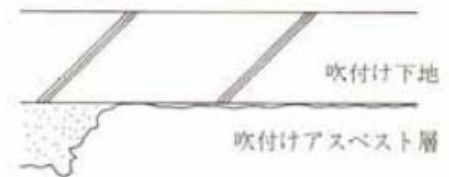
⑥ 層の損傷・欠損
