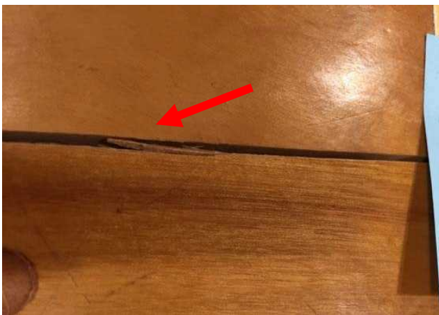
図10 長辺部分に発生した割れ
