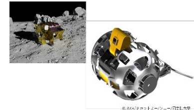
SLIMに搭載予定の変形型月面ロボット SORA-Q （宇宙探査イノベーションハブ研究の一例）
