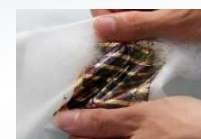
衣服上に貼り付けた超薄型有機太陽電池の洗濯写真
