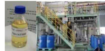
タイ科学技術研究院(TISTR)内に設置されたパイロットプラント(1トン/日規模)とH-FAME燃料。通常の燃料製造施設内に付帯設備として設置可能。
