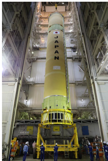
2024年4月2日 1段機体射座据付け(VOS)
