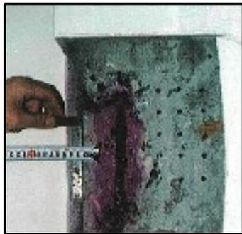
柱のコンクリート中性化深さ試験
