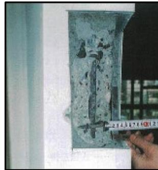
柱の鉄筋かぶり厚さ測定
