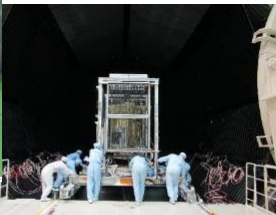
システム試験中のSLIM（左:振動試験前, 右:熱真空試験前）
