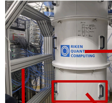
上半分は、超伝導を起こすための極低温冷却装置
