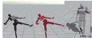
姿勢のモーションキャプチャ(赤)から、関節トルクを含む仮想力学系(黒)の挙動を復元することで、自然なアニメーションを生成することができる。擾乱への反応も自然である(右図)
