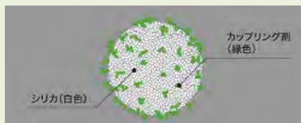
↑「京」で作成したシリカの粒子にカップリング材が結合しているモデル図
