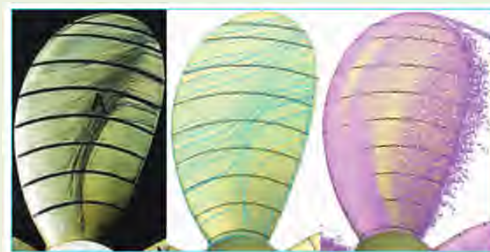
← 左: 縮尺模型に色付き油を塗布した実験結果 中・右: 「京」シミュレーションを可視化した図。ピンク色の飛沫に見える粒は、高速回転時の表面における微細な渦を表す
