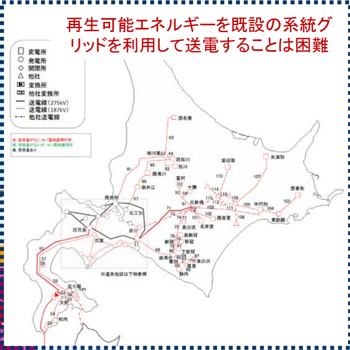
系統空き容量マップ(2019年6月6日更新) (北海道電力株式会社 ホームページより抜粋)
