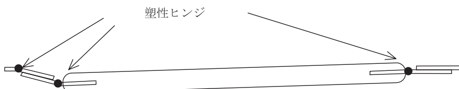
図 4.1 鋼管に一枚のガセットプレートが割り込まれた筋かいの座屈変形
