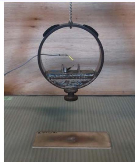
転倒衝突時の床のかたさ測定装置(JIS A 6519)
