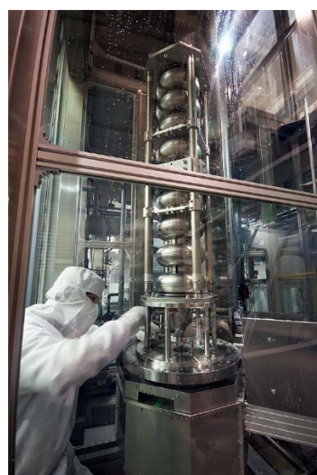
図 III-7-3 超音波洗浄設備および超純水高圧洗浄設備の例
