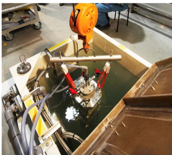
図 III-7-3 超音波洗浄設備および超純水高圧洗浄設備の例
