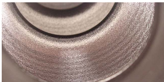
図 III-9-3 液圧成形後の空洞内部
