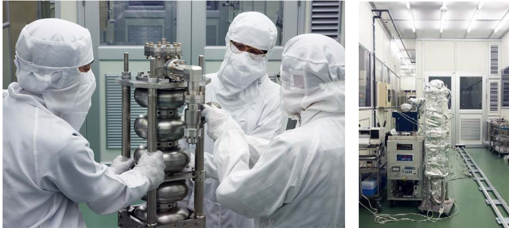
図 III-7-4 クリーンルーム内でのアンテナや閉止フランジの取付け作業、および 120℃ベーク作業の例
