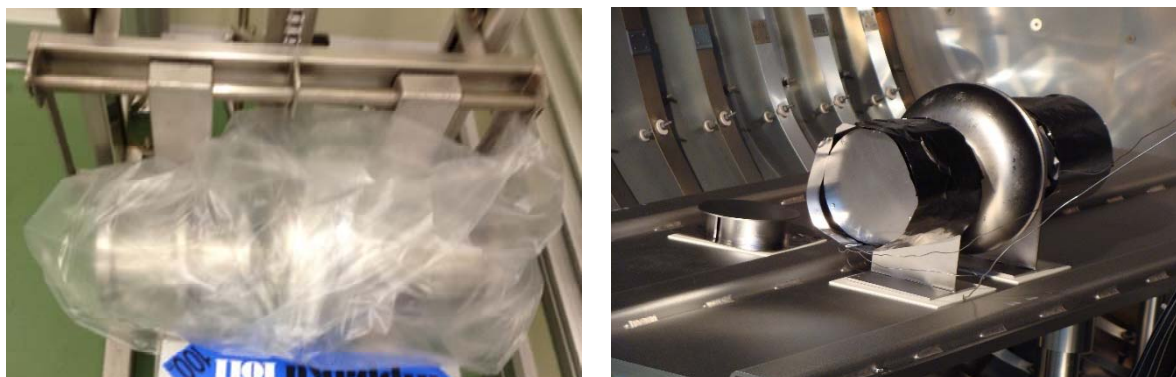
図 III-4-3 （左図）クリーンルーム内でパッキングされた単セル空洞。（右図）真空炉へインストールする際に、Nb 製キャップならびに Nb フォイルでフランジを覆われた単セル空洞。
