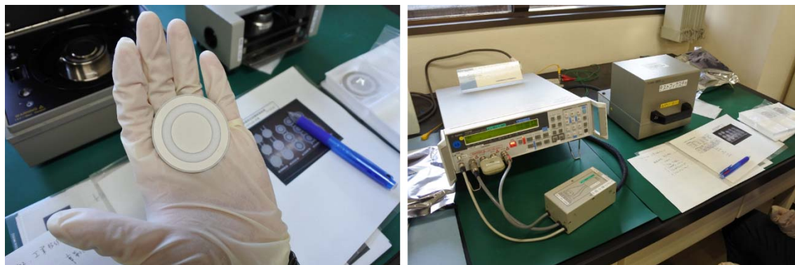
図 III-6-3 円盤状セラミックサンプル（左）と表面抵抗測定装置（右）
