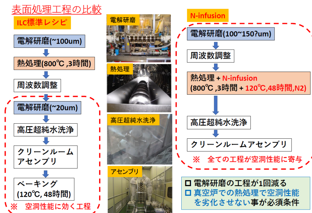
図 III-4-2 ILC 用の標準表面処理レシピと N-Infusion の場合の工程の比較
