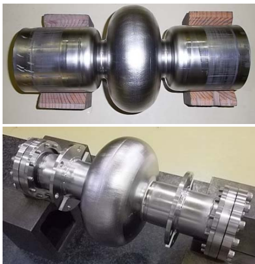
図 III-9-2 ネッキング加工機（左）、成形が完了したニオブパイプ（右上）、完成した 1 セルの空洞（右下）
