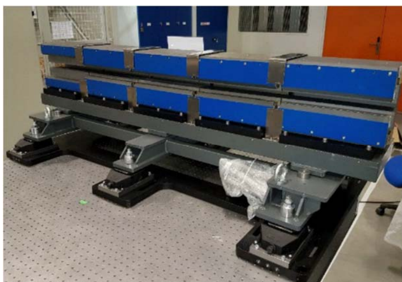
図 II-3-7 5 連の永久磁石ユニットからなる ESRF-EBS の偏向磁石 (出典：文献 II-3-3)
