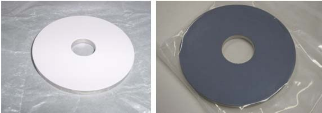
図 III-6-4 TiN コーティングを施した従来のセラミック（左）、TiN コーティングの無い新型セラミック（右）
