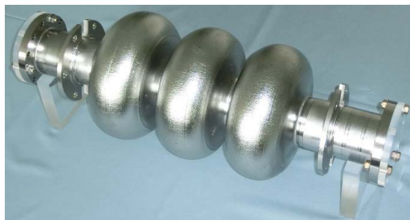
図 III-9-4 KEK で液圧成形により製造された 3 セルの空洞
