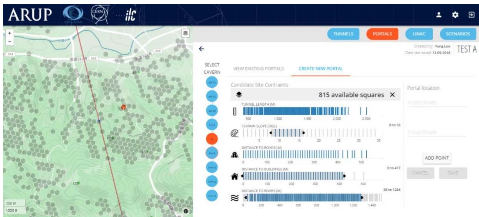
図 III-10-10 T0T ソフトウェアによる地形図上への斜坑坑口マッピングの例。五つの探索条件を現実に即した設定にした場合のアクセスポータル（候補坑口）は、地上部の灰色の六角点群まで絞られる。
