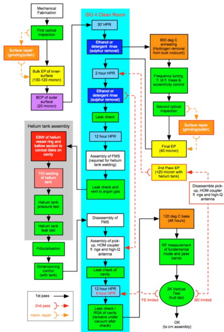
図 III-7-1 TDR における超伝導加速空洞の表面処理フローの全体図。黄色いボックス部分が電解研磨プロセスである。また、濃い青のボックス部分が超音波洗浄プロセス、薄い青ボックスが超純水高圧洗浄プロセスである。
