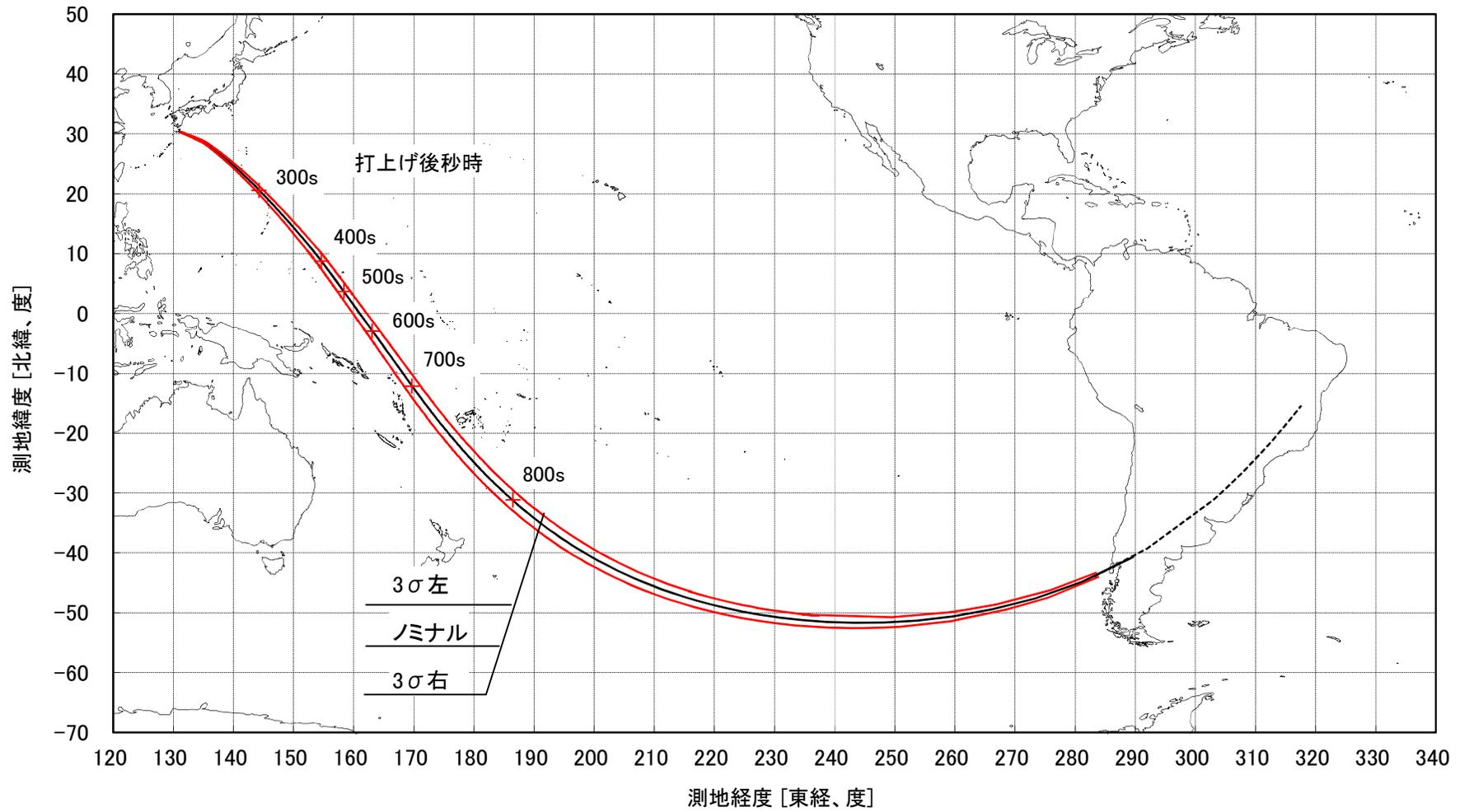
図5 ロケットの落下予測点<sup>(注)</sup>軌跡と3σ分散範囲
