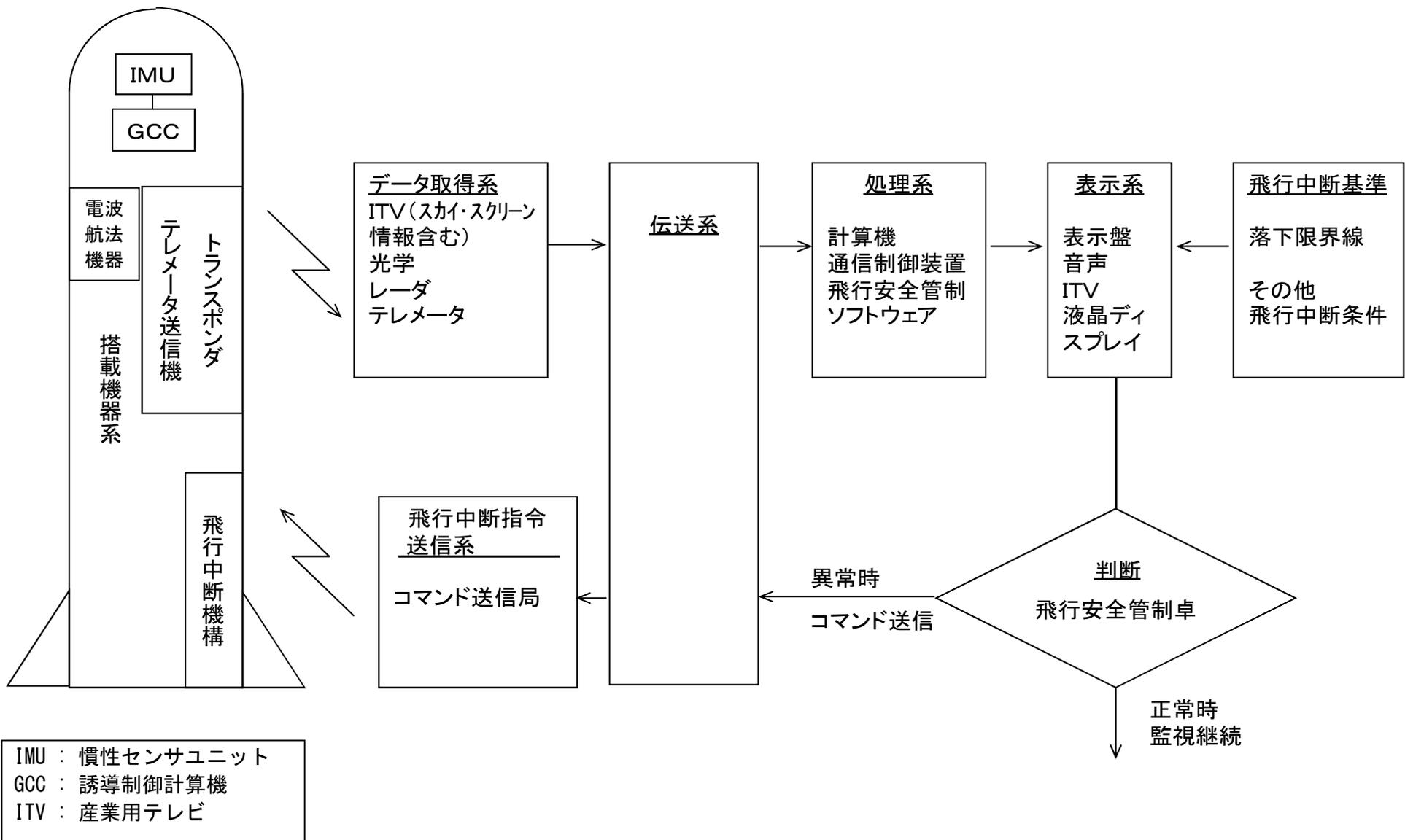
図6 飛行安全システム概念図
