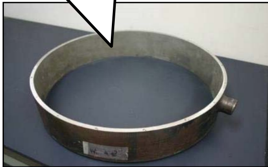
「もんじゅ」改造工事で切断した 2次主冷却系配管
