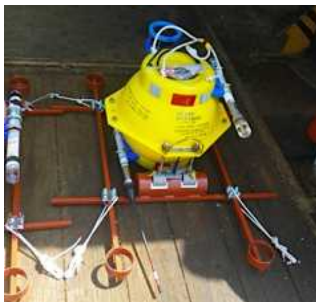
図 4. 現在広く用いられている海底地震計と機構及び外寸・重量の互換性を維持した超深海型海底地震計 (UDObs)。設置する前の船上で固定されている状態である。ガラス球を耐圧容器に用いた従来の海底地震計と同じ設置及び回収手順で観測運用可能である（東大地震研 [課題番号：1432]）。
