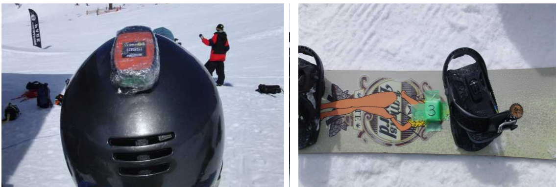
写真 1 実験に使用した GPS（左）と慣性センサー（右）
