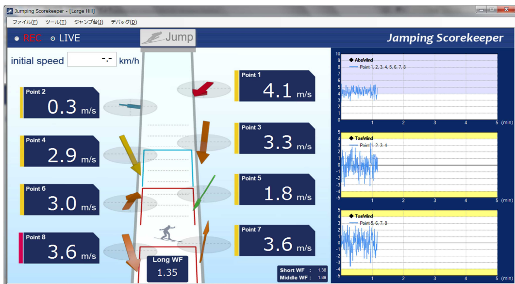
写真 3 超音波方式 3 次元風向風速計測システム
