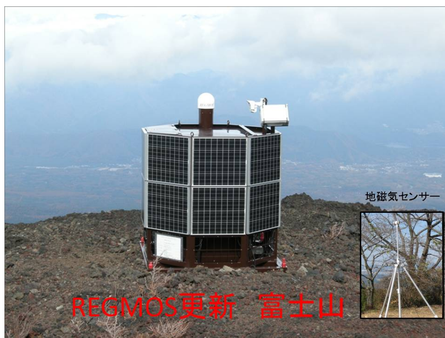
図1 GPS 火山変動リモート観測装置 ( REGMOS )
