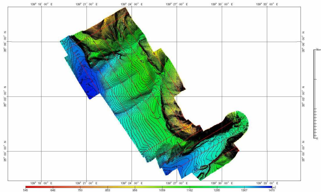
図1 マルチビーム測深作業の航跡図。
