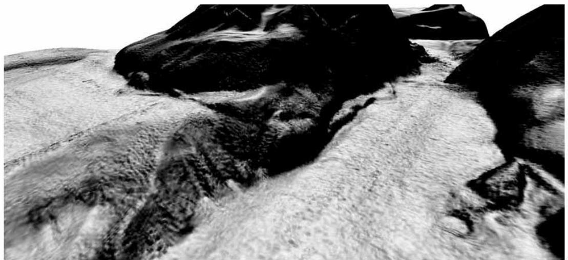
図2 上：既存の詳細 DEM ( 3秒 = 90 m グリッド DEM ) から作成した東京海底谷 , 相模トラフ出口付近の 3 D 画像 . 西から東を望む . 下 : 本年度調査によって得られたデータをもとに作成した 0.5 秒 = 15 m グリッド DEM から作成した同地点の画像 .
