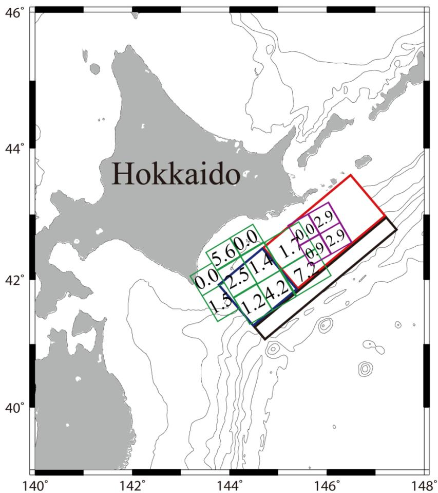
図1 全ての津波堆積物調査地点を説明できる北海道太平洋沖17世紀の巨大地震の断層モデル
