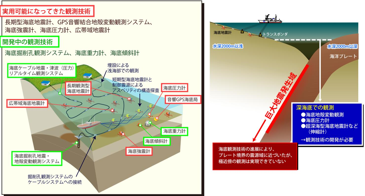
図14 (海底観測装置の開発状況) 海底観測を可能にする様々な観測装置の開発が進んだ。しかしながら、海溝軸地殻の水深6000m以深での観測装置の開発が課題となっている。
