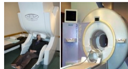
脳科学研究用に特化改良された全頭型の脳磁計 (MEG) ヒトや実験動物において計測可能な機能的MRI生理画像解析装置 (fMRI)
