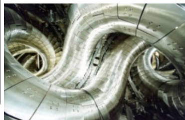
◆ LHD内部の真空容器 30立方メートルの温度1億度のプラズマを閉じ込める。
