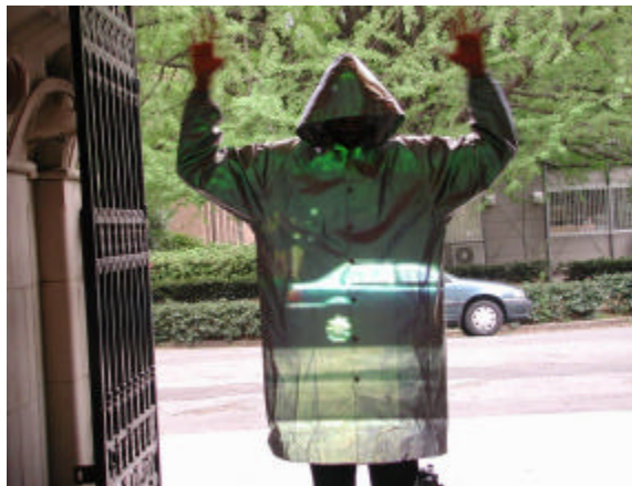
図 1 1 物体の後ろに配置したビデオカメラの映像をイメージ・ベースト・レンダリングの手法で観測視点の映像に変換し、RPTを用いて投影することであたかも人間が透明であるかのように提示できる。
