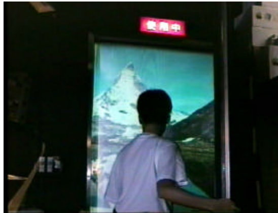
図 1 0 壁に再帰性反射材の壁紙を貼ることで、普通の部屋を立体視可能な没入型提示環境に変えることができる。
