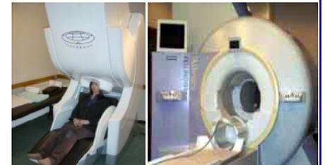
脳科学研究用に特化改良された全頭型の脳磁計 (MEG) | ヒトや実験動物において計測可能な機能的MRI生理動画像解析装置 (fMRI)
