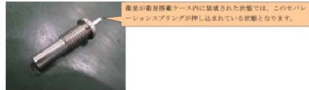
図2 セパレーションスプリング外観 (パネは内蔵されている)
