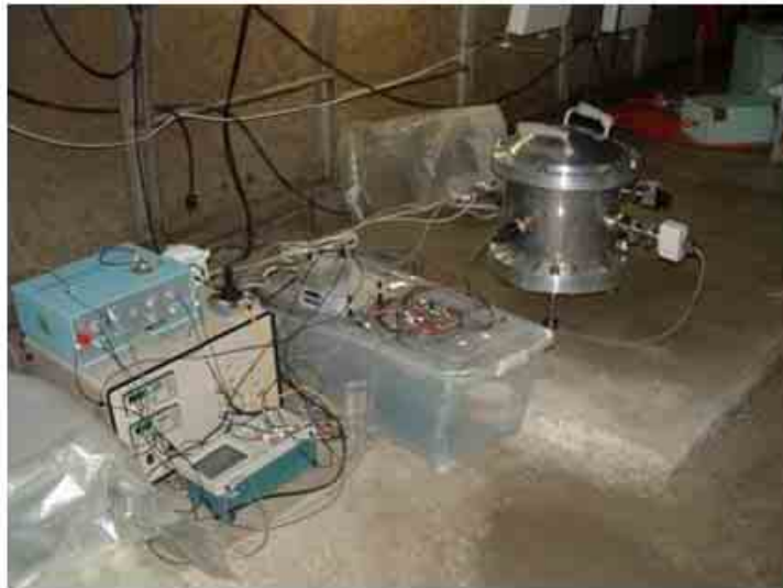
図7. 静穏な実験室における小型絶対重力計の精度評価。2010 年5 月および10 月に試作絶対重力計の性能評価を実施した。再現性や統計的なばらつきの値から、市販の絶対重力計と同等の性能と評価された。青は絶対重力値であり、理論潮汐（赤線）とよく一致している（橙はその残差）。なお、このときの地面振動を茶色で示す（装置の振動検知機構により測定値から除去される）（東京大学地震研究所[課題番号：1439]）。
