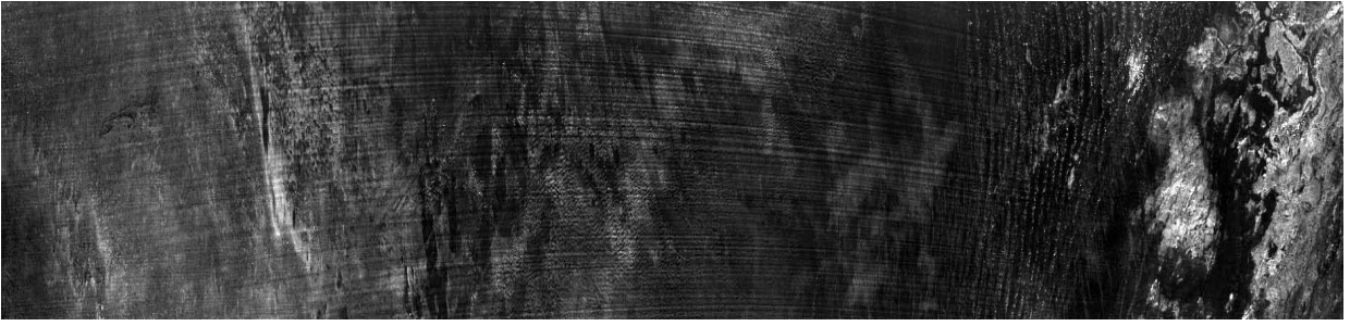
図7 南米で見られた筋状雑音（プラズマバブルとの関連性による）：島田他
