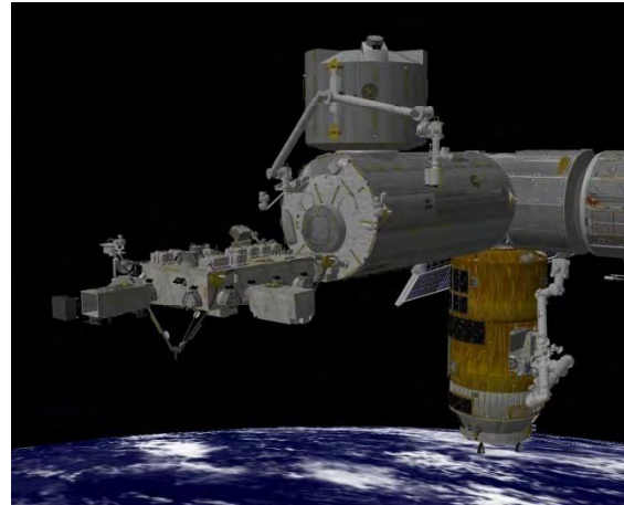
2 HTVから曝露パレットをISSロボットアームにより取り外す
