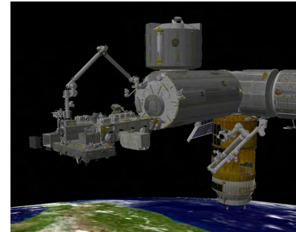
5 「きぼう」ロボットアームにより船外実験プラットフォームに取り付ける
