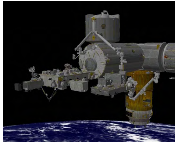
4 曝露パレットを「きぼう」ロボットアームに引き渡す
