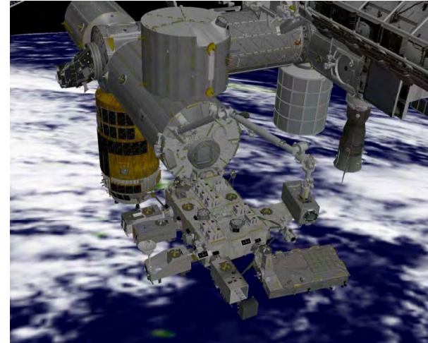
曝露パレットから船外実験プラットフォームに移送
