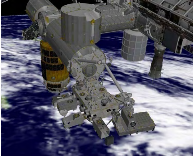
曝露パレットから「きぼう」ロボットアームによりMCEを取り外す
