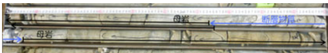
図1．Ezulwini 鉱山のわれわれの観測孔のコア 断層の位置がはっきりわかる．
