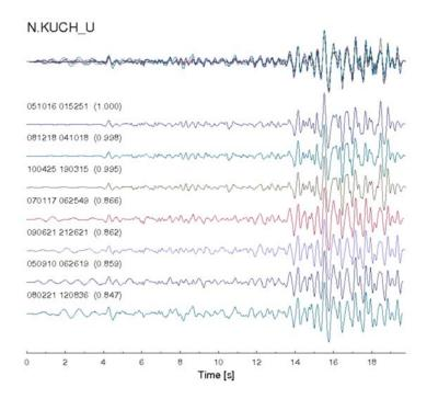
図 1 相関係数の値の順に並べた波形. 括弧内の数字は (1.000) の波形との相関係数を表す. 最上段は全てを重ねて描いた波形.
