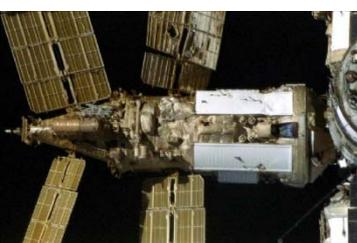
プログレスの手動ドッキング試験中にミールへ衝突。太陽電池パネルやラジエータパネルが破損。与圧壁に穴が空いて、減圧が発生した。(平成9年6月)
