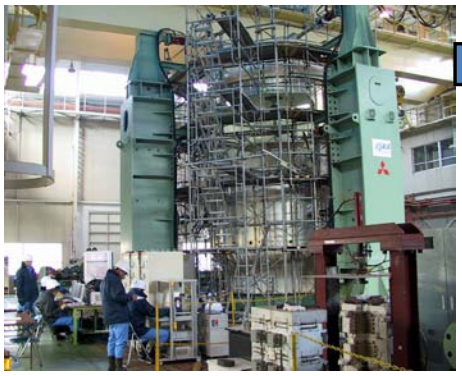
(開口部を含む)大型構造物強度試験
