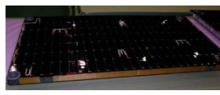
太陽電池(シャープエッジ対策)
