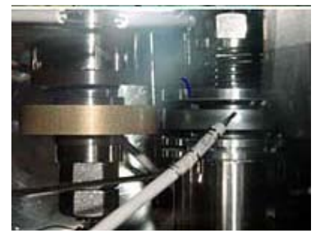
真空高温槽でのホイール試験
