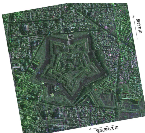
図1 航空機 SAR ( Pi-SAR2 ) で観測した五稜郭の画像 (1.2kmx1.2km)。分解能は約30 cm。
