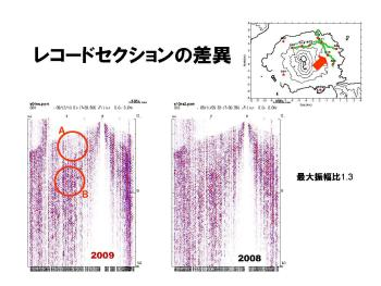
桜島北東部における反復反射法探査により得られたペーストアップの比較
