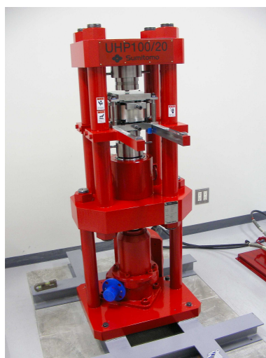
図 2：東京大学の固体圧式変形試験機 ( 100 トンプレス )
