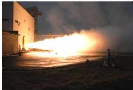
地上燃焼試験(観測ロケット級)
