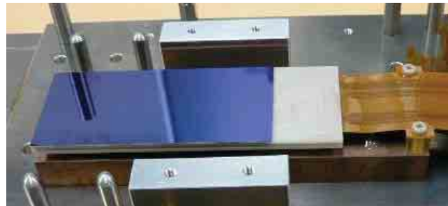
図1：国内メーカーと共同開発した、N型シリコンを使ったCCD
