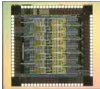
図1：国内メーカーと共同開発した、N型シリコンを使ったCCD
