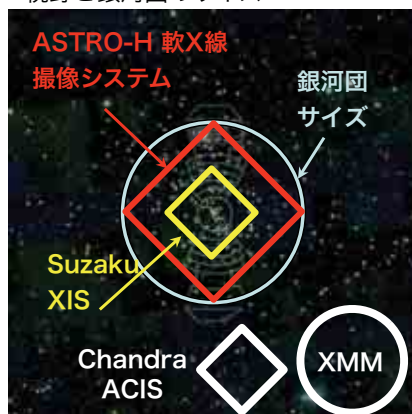
軟X線撮像システム(SXT-I+SXI)の視野と銀河団のサイズ
